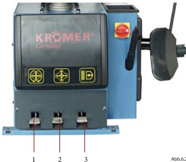
1. **Montageteller Drehrichtung:** Montageteiler im Uhrzeigersinn/ gegen den Uhrzeigersinn drehen
