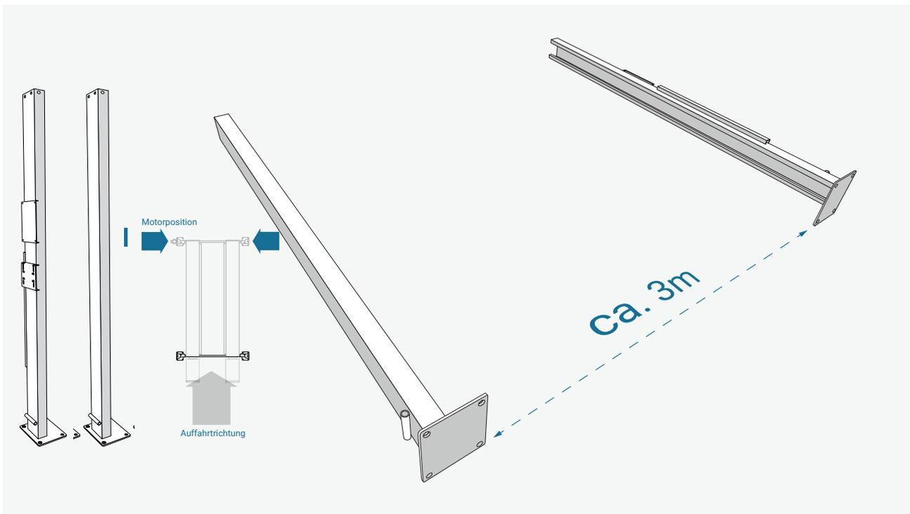
Legen Sie die Säule mit Aufsatz für den Motor ( $C_1$ ) und eine der anderen ( $C_2$ ) ungefähr 3m voneinander entfernt auf den Boden.
