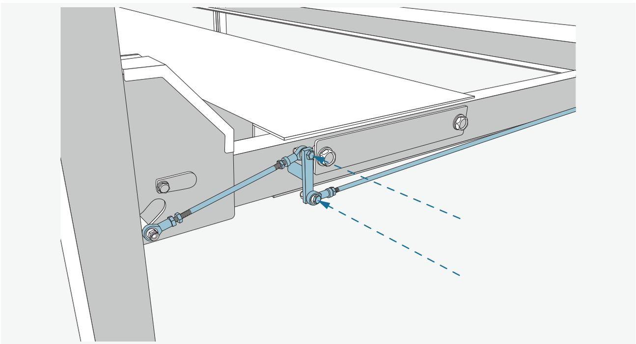
Schrauben Sie nun auf der anderen Seite die Rastenbauteile zusammen an die senkrechte Halterung.
