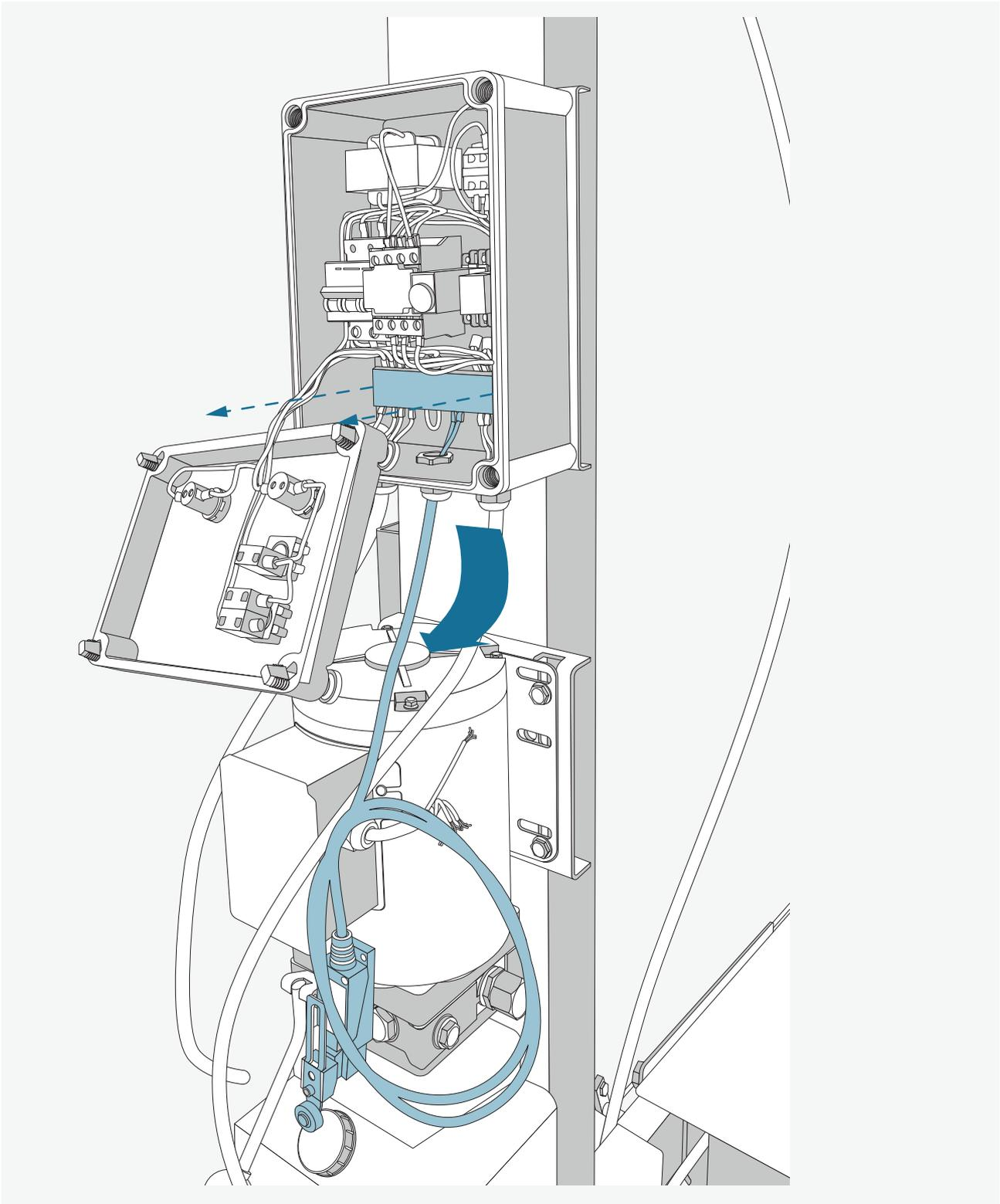
Nehmen Sie die Abdeckung der Klemmleiste ab und entfernen Sie die Kabel den angeschlossenen Endabschalter samt Elektrokabeln.
