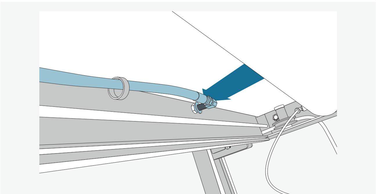
Schließen Sie den Hydraulikschlauch im Inneren der Hauptplattform durch die vorgesehene Öffnung.
