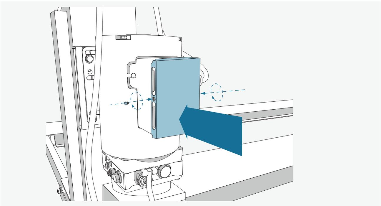
Anschließend können Sie die Abdeckung des Elektrikgehäuses des Motors wieder anbringen.
