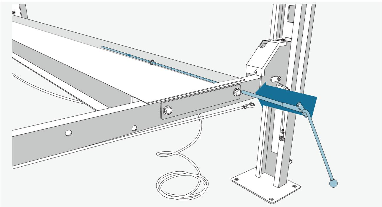
Schieben Sie Ver- und Entriegelungsstange mit Hebel durch Hauptplattform innerhalb der Rampe.
