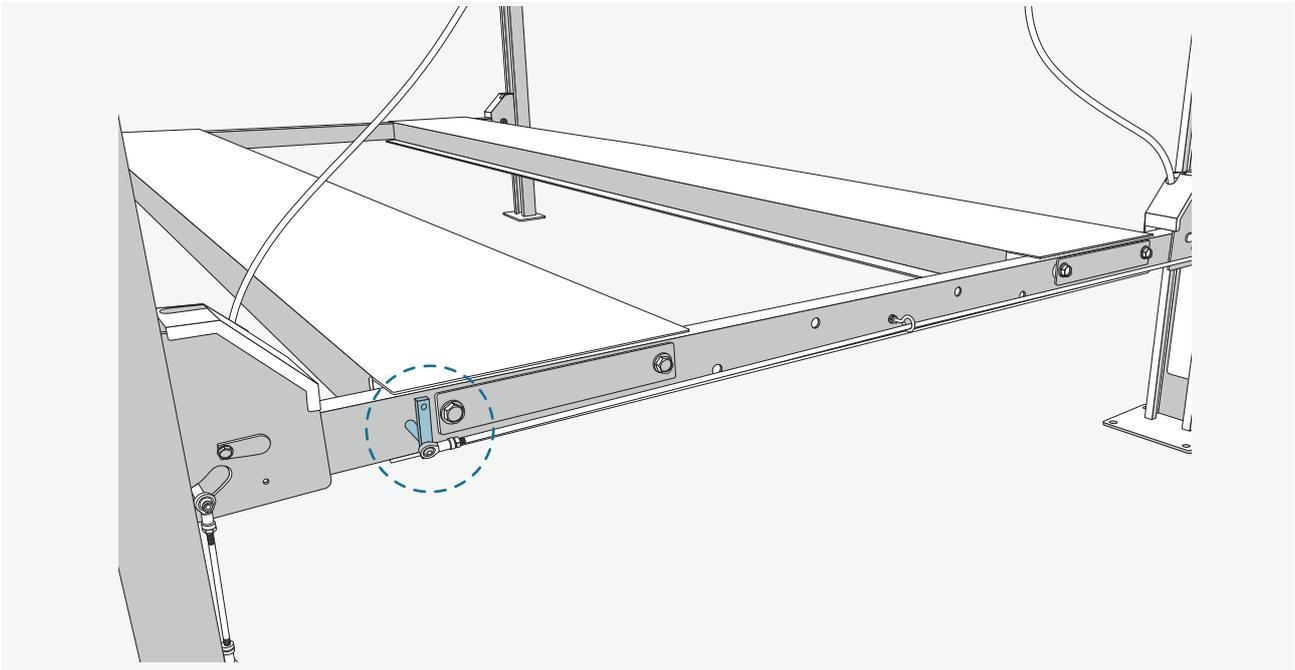
Achten Sie darauf, dass die Schraubenhalterung aufrecht, bzw. senkrecht zum Boden steht.
