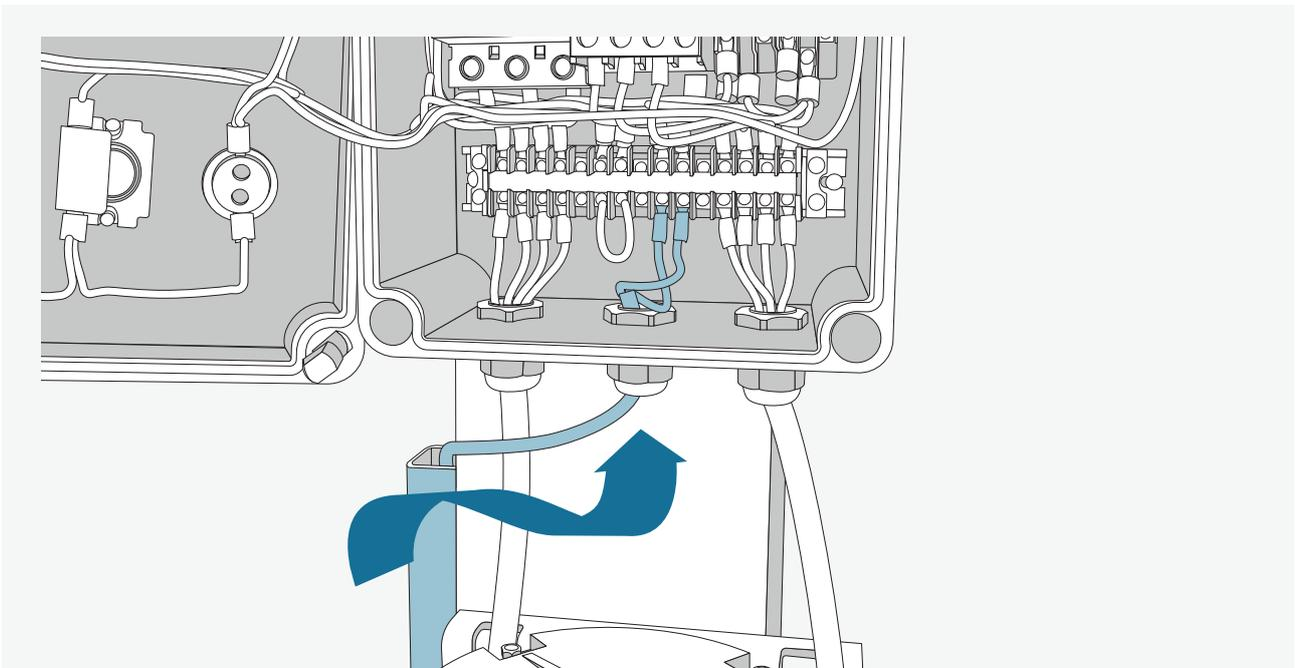
Schließen Sie den Endabschalter wieder an die Klemmleiste an.
