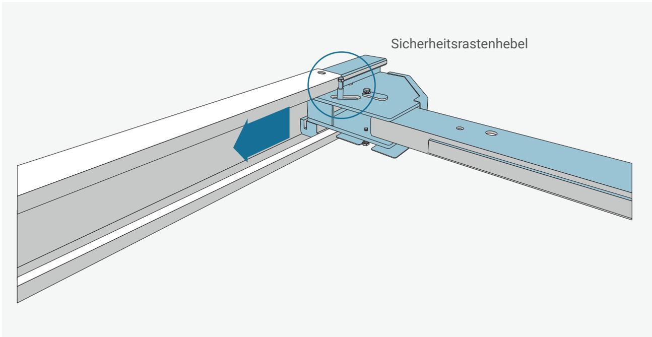
Führen Sie die Quertraverse wie dargestellt in die oberen Enden der Säulen ein. Achten Sie darauf, dass der Sicherheitsrastenhebel sowie die Halterung des Bautenzuges nach außen zeigen.
