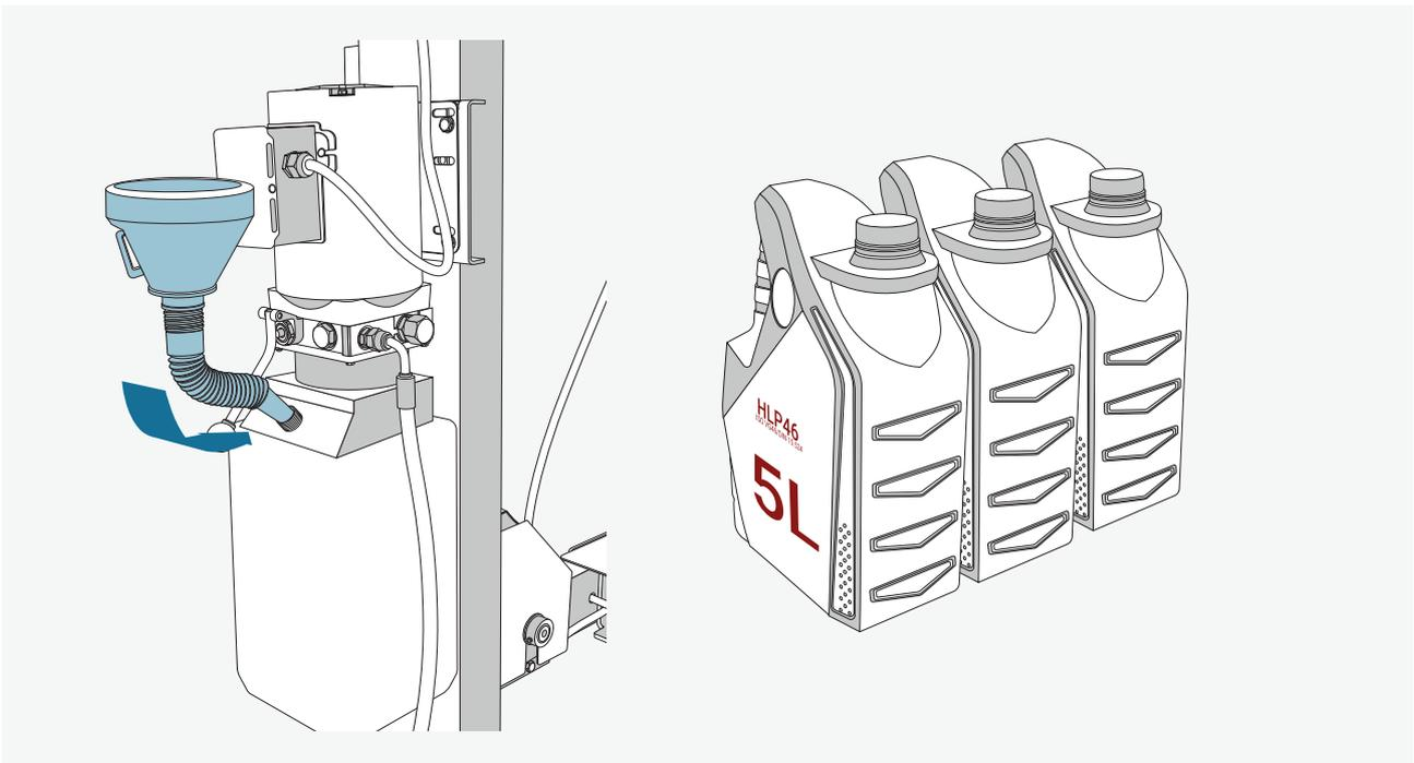
Nutzen Sie einen Trichter an der Öffnung des Hydrauliktanks, um das Bedienpult zu befüllen. Es werden ungefähr 15 Liter Hydrauliköl benötigt.
