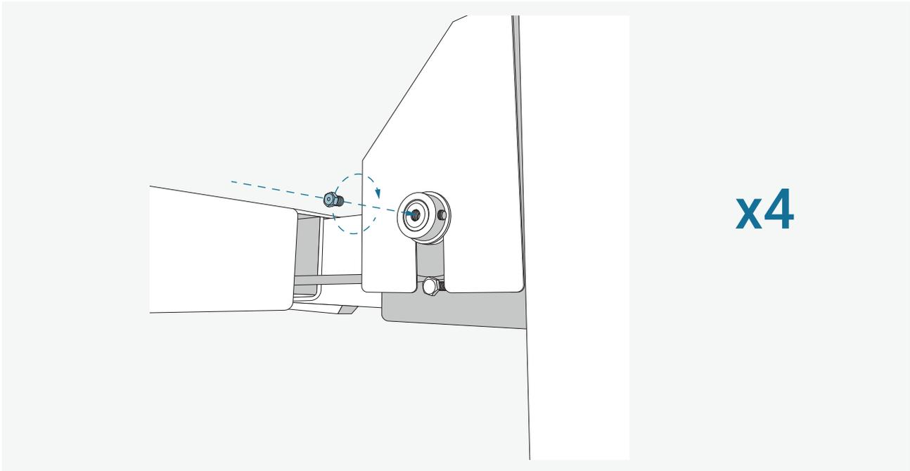
Befestigen Sie die Rollen an den Rampenhaltern mit der Sicherungsschraube (r)
