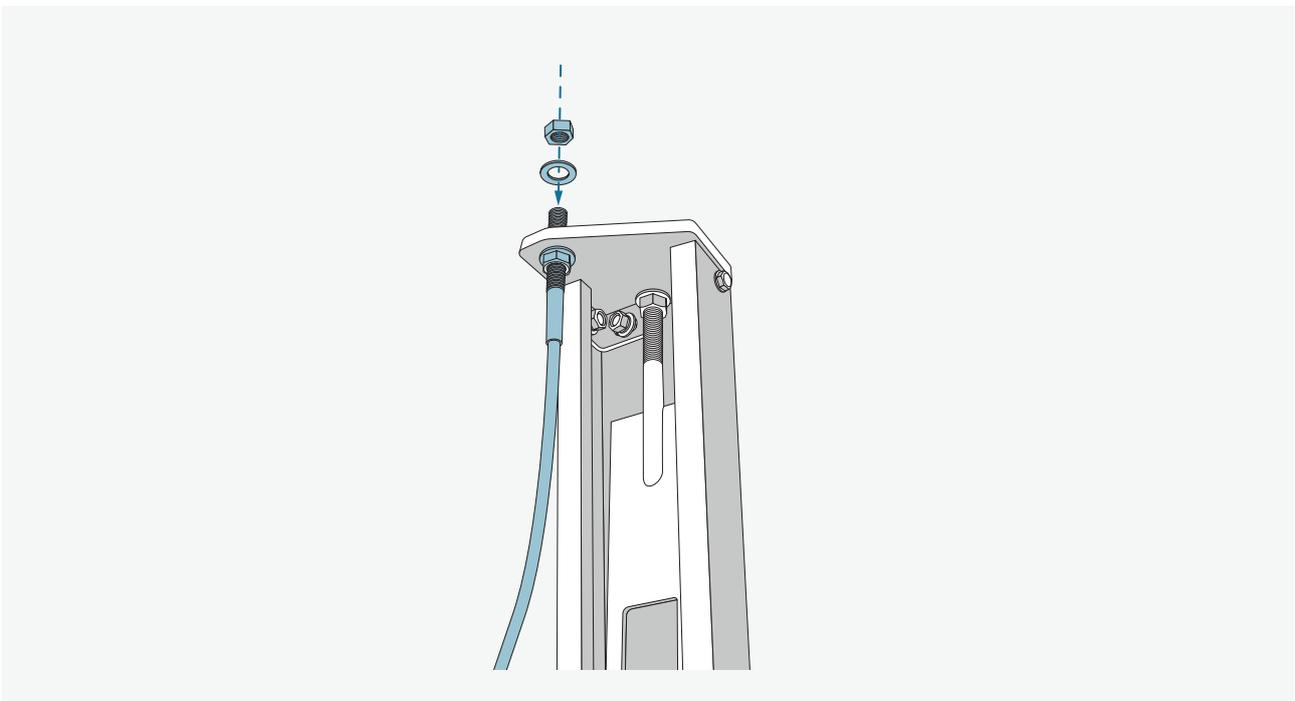
Haben Sie die Abdeckung wie in Punkt 7 angebracht, können die Gleichlaufseile in der Säulenabdeckung verschraubt werden.
