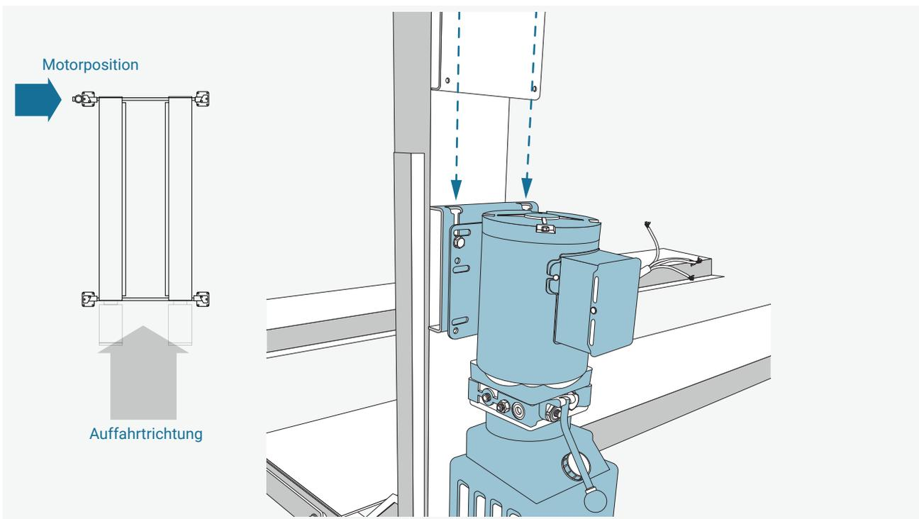
Hängen Sie anschließend den Motor in die Säule mit Motorhalterung.
