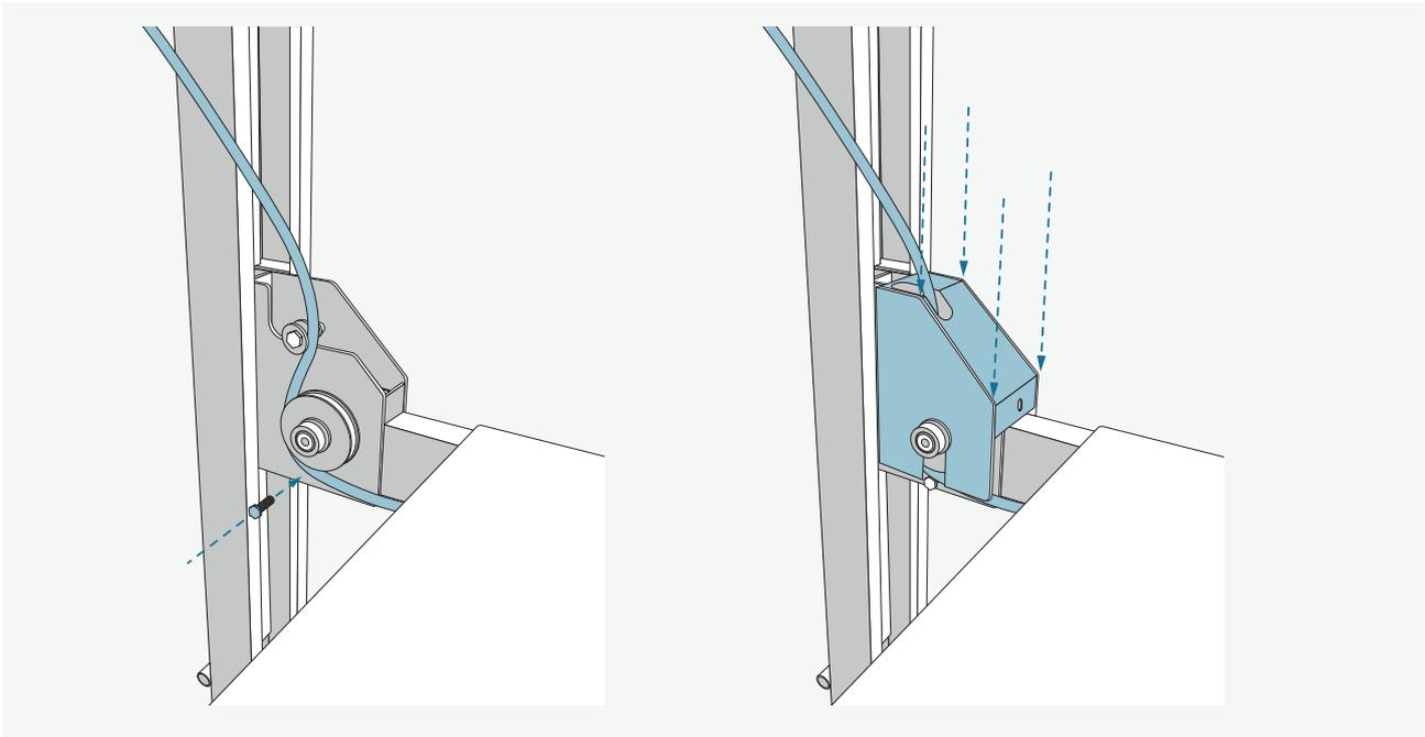
Schrauben Sie die Schraube unterhalb der Rolle wieder ein, um das Seil zu fixieren. Anschließend kann die Abdeckung wieder angebracht und verschraubt werden.
