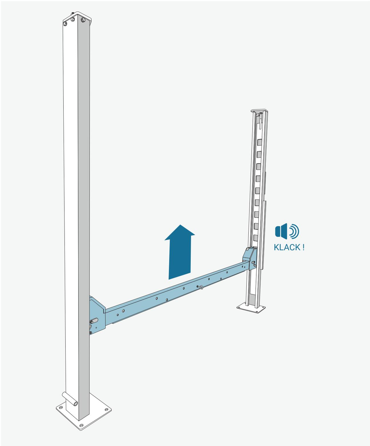
Schieben Sie jeweils die Quertraversen (B) soweit hoch, bis das Klackgeräusch beim Einrasten in die erste Sicherheitsraste (z) hörbar ist.
