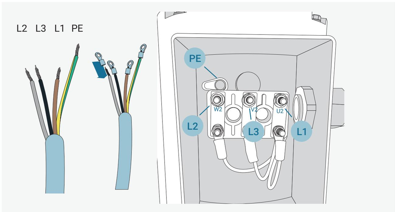
Bringen Sie an dem vom Bedienpult ausgehenden Kabel Steckaufsätze an, um es am Motor anzuschließen. Bsp: 400 Volt
