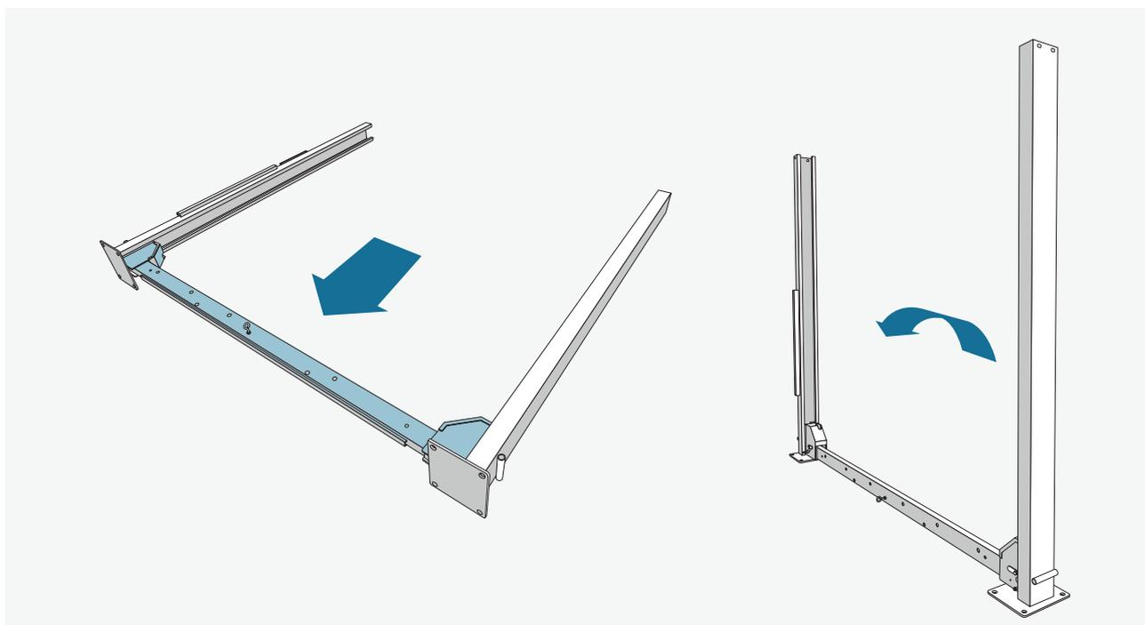
Wiederholen Sie den Vorgang für die beiden anderen Säulen, Die Rampenhalterung sollte in die entgegengesetzte Richtung ausgerichtet sein. D.h. Sicherheitsrastenhebel und Halterung des Bautenzuges sollten nach außen zeigen.
