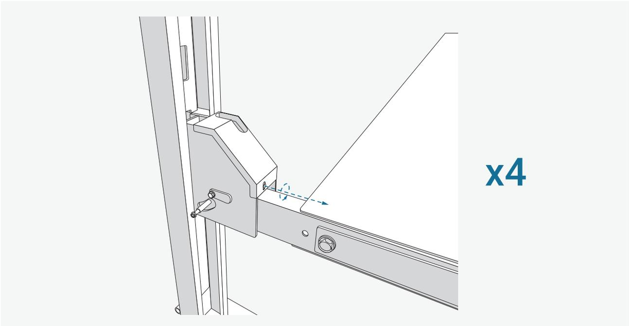
Entfernen Sie hierzu zuerst die jeweilige Schraube an Abdeckung der Gleichlaufseilenhalterung an allen Säulen.
