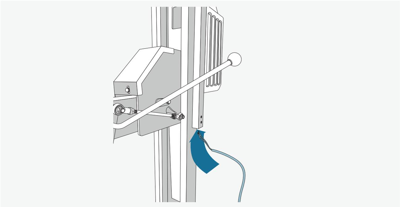
Leiten Sie das Kabel des Endabschalters durch die Halterung an der Seite der Säule x1.
