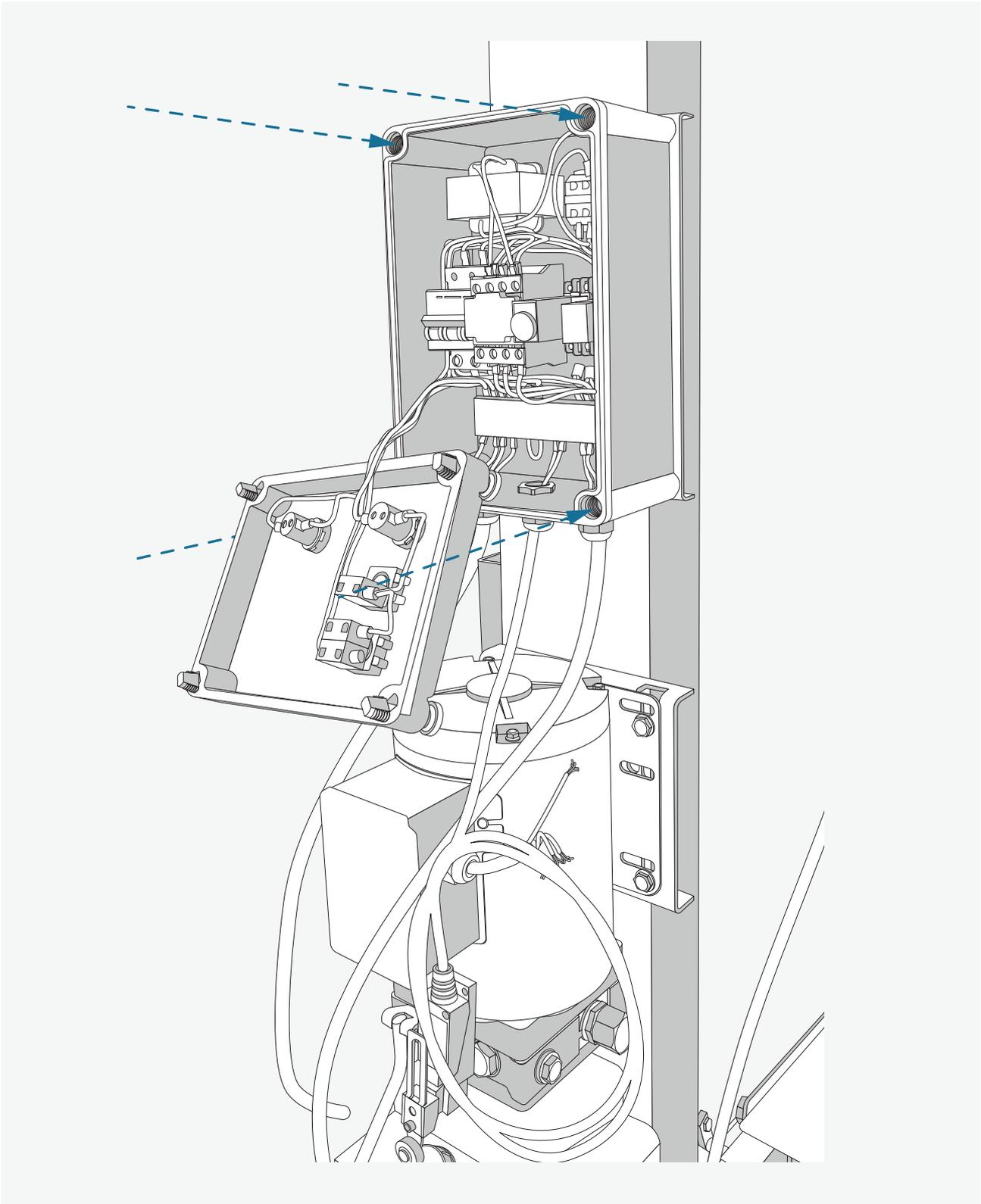
Schrauben Sie das Bedienpult über dem Motor in die Schraublöcher fest.
