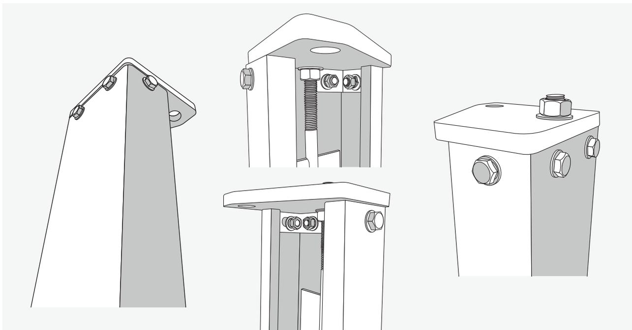
Befestigen Sie 4x die Säulenabdeckungen (e) an allen Seiten mit Sperr- und Sicherungsringen.
