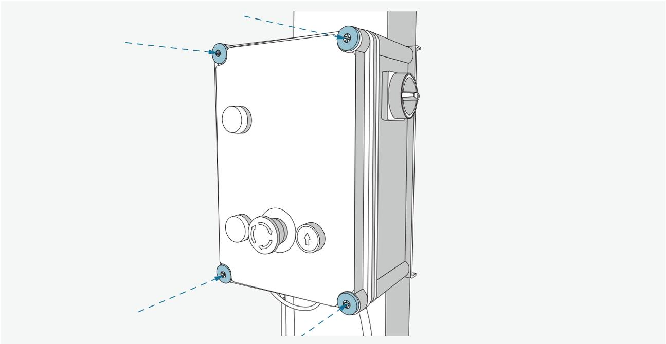
Ist der Motor angeschlossen, kann das Bedienpult zugeschraubt werden, nutzen Sie dafür die bereits angebrachten Schraubensätze auf dem Deckel des Bedienpultes.
