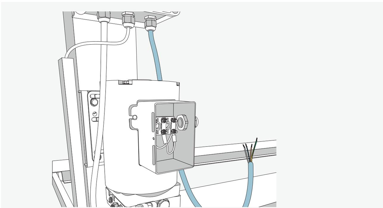
Es gilt nun, das Kabel aus dem rechten Kabeldurchgang des Bedienpultes an den Motor anzuschließen.
