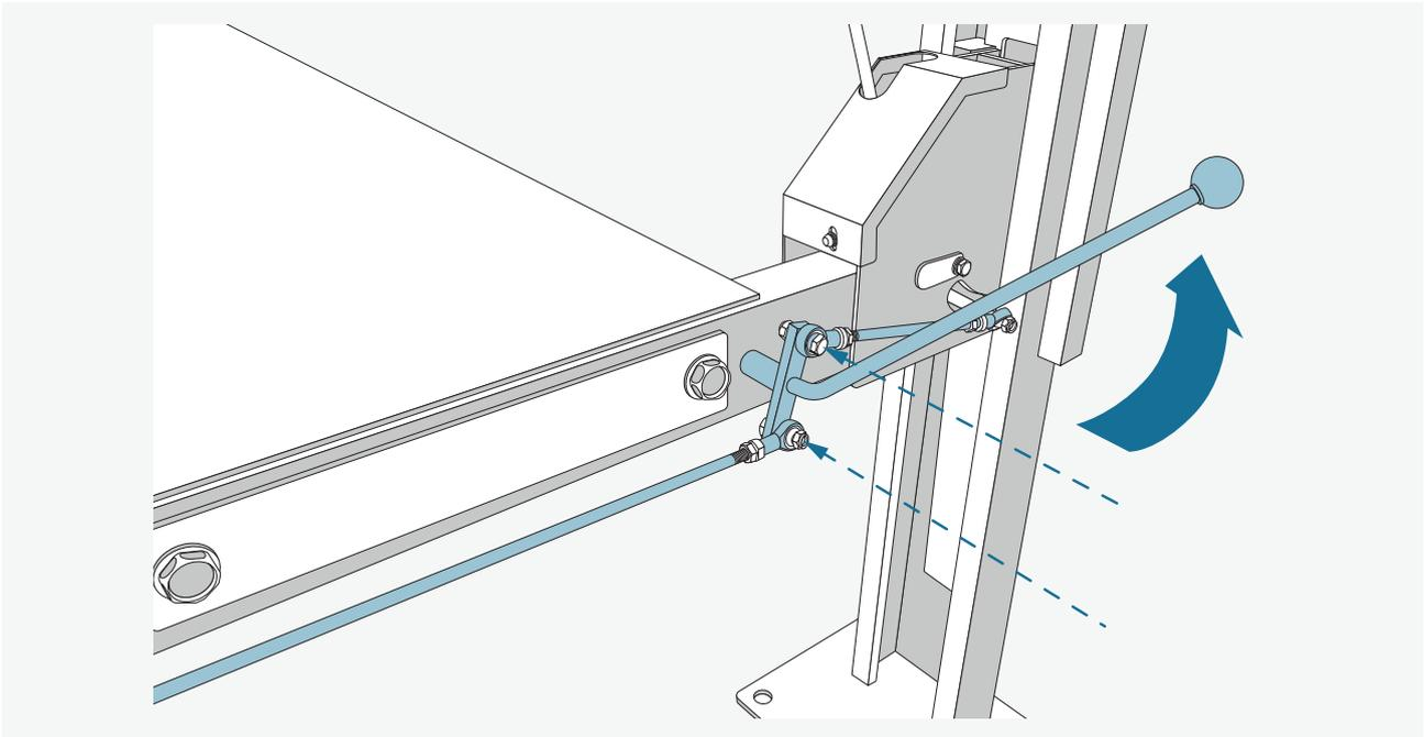
Achten Sie ebenfalls auf der Hebelseite auf eine senkrechte Haltung, drehen Sie vor dem zusammenschrauben den Hebel ggf. nach oben und Schrauben Sie die beiden Rastenbauteile an das Hebelbauteil an.
