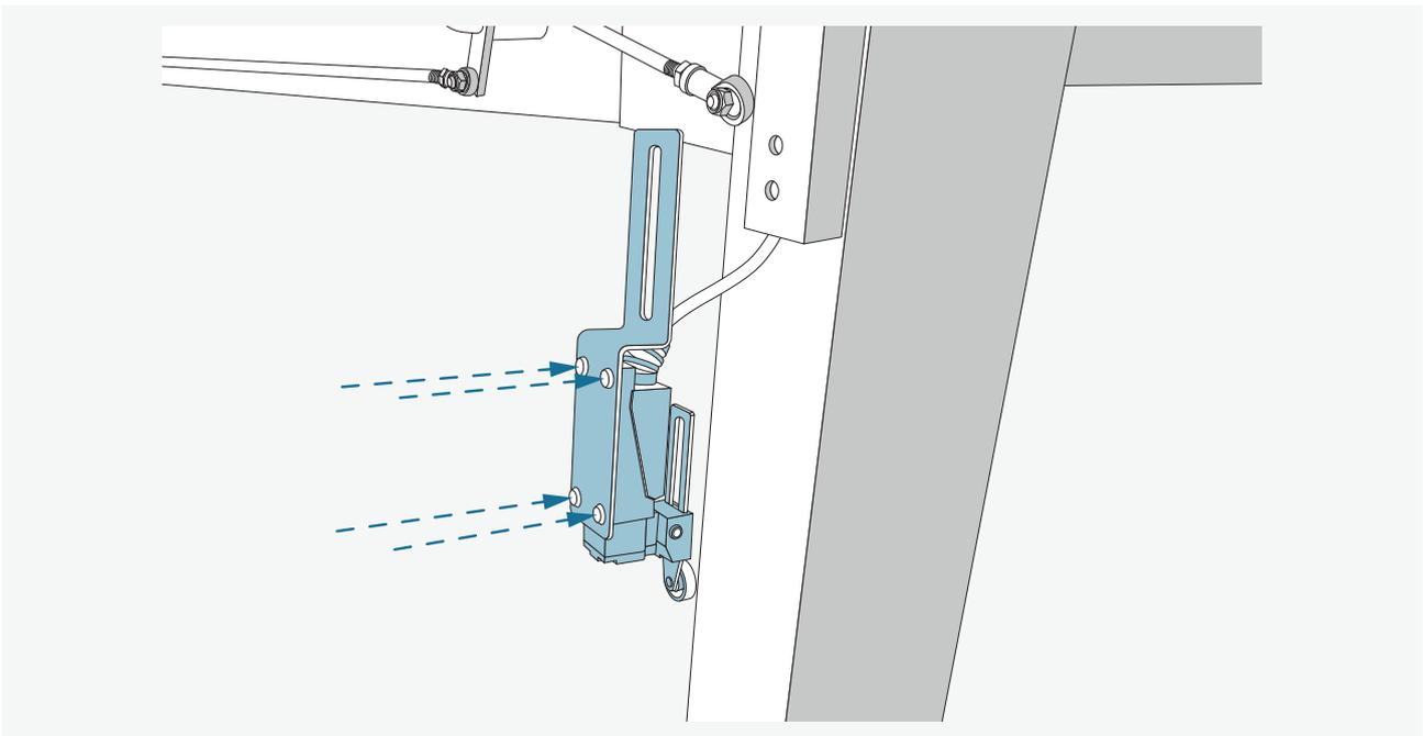
Schrauben Sie die Endabschalterhalterung (m) an den Endabschalter an.
