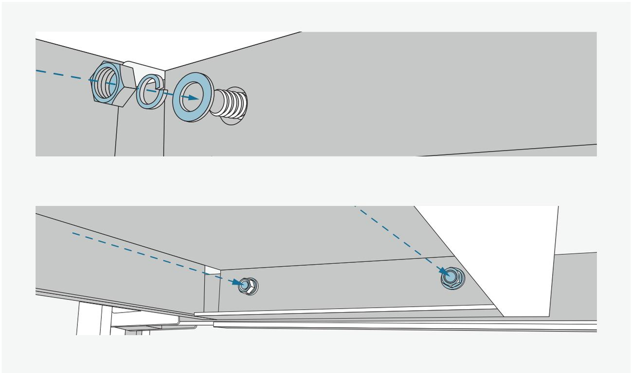
Schrauben (j) werden an Außenseite der Quertraversen eingeführt. Dann die Schraube mit einer Unterlegscheibe, Federrung und dann Mutter an der Innenseite der Plattformen befestigen.
