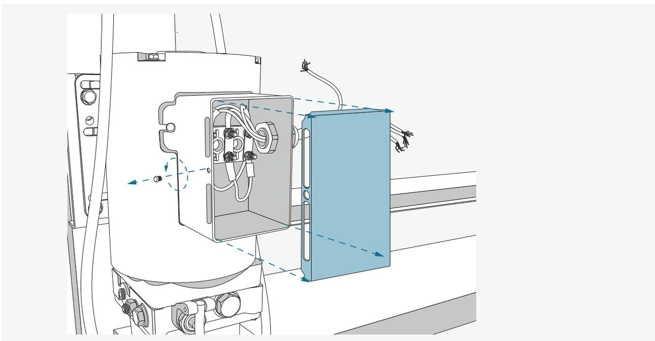
Schrauben Sie das Elektrikgehäuse des Motors auf.
