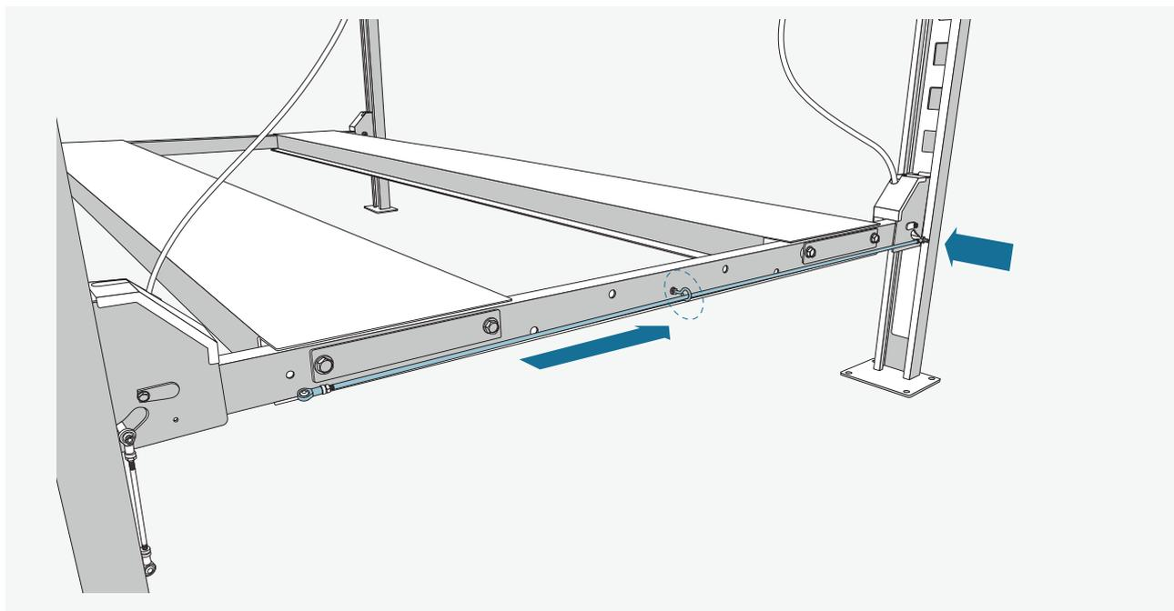
Ziehen Sie die lange Stange der Raste durch den Haken der Quertraversen durch und schrauben Sie es auf den Sicherheitsrastenhebeln der anderen Seite rauf, um die Stange zu befestigen.
