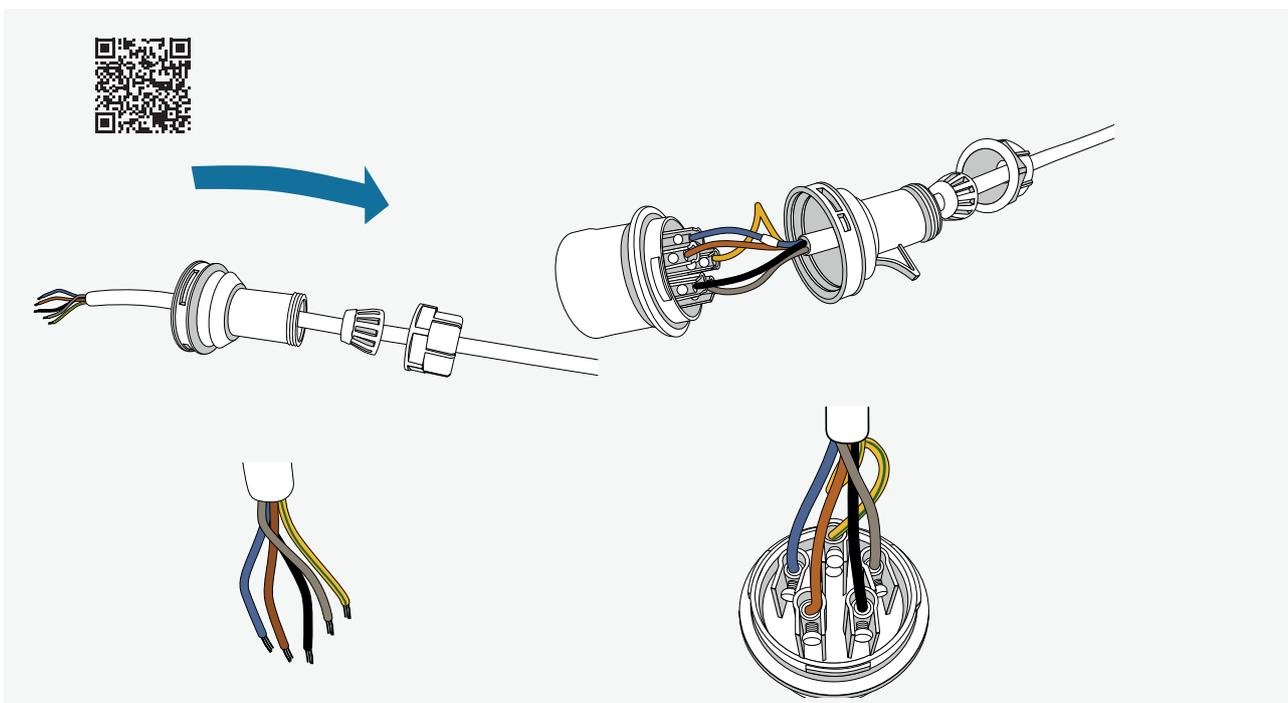
CEE Stecker (f) je nach Bedienpult anschließen. Bsp.: 400 V
