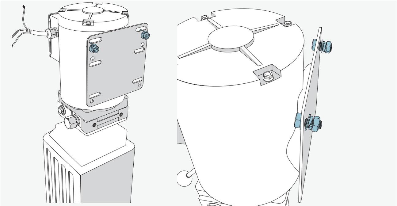
Bringen Sie zuerst in Sperring, Seegering sowie Schraube und Mutter lose in die obere Halterung der Rückseite des Motors an.
