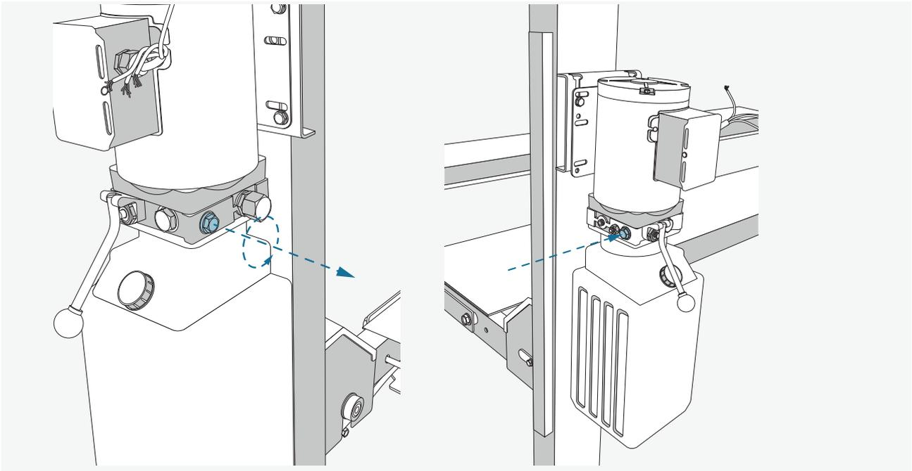
Schrauben Sie die Mutter am Pumpenblock des Motors ab und schrauben Sie es auf der anderen freien Stelle des Pumpenblockes wieder an.
