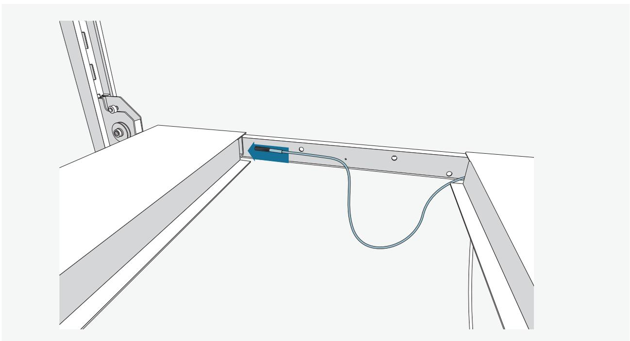
Führen Sie anschließend das Gleichlaufseil von der Hauptplattform zur Nebenplattform
