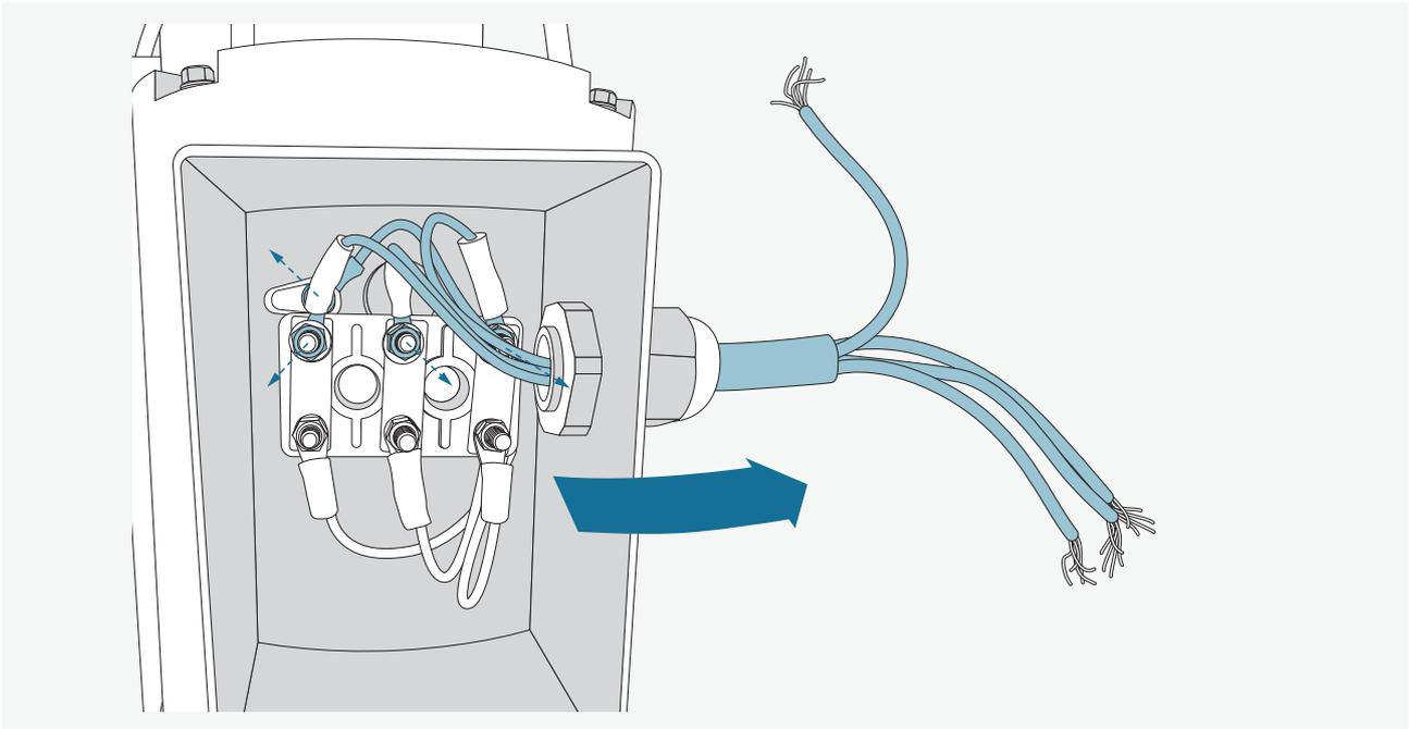
lösen Sie zuvor das bereits angebrachte Kabel innerhalb des Elektrogehäuses des Motors.
