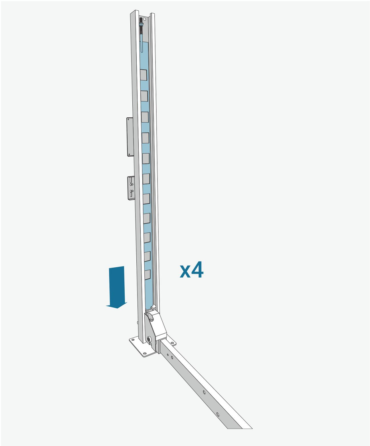
Montieren Sie 4x die Sicherheitsrasten (z) in die jeweilige Säulenführung (C<sub>1</sub>, C<sub>2</sub>, C<sub>3</sub>, C<sub>4</sub>). Dabei wird die Sicherheitsraste in die Quertraverse geschoben.
