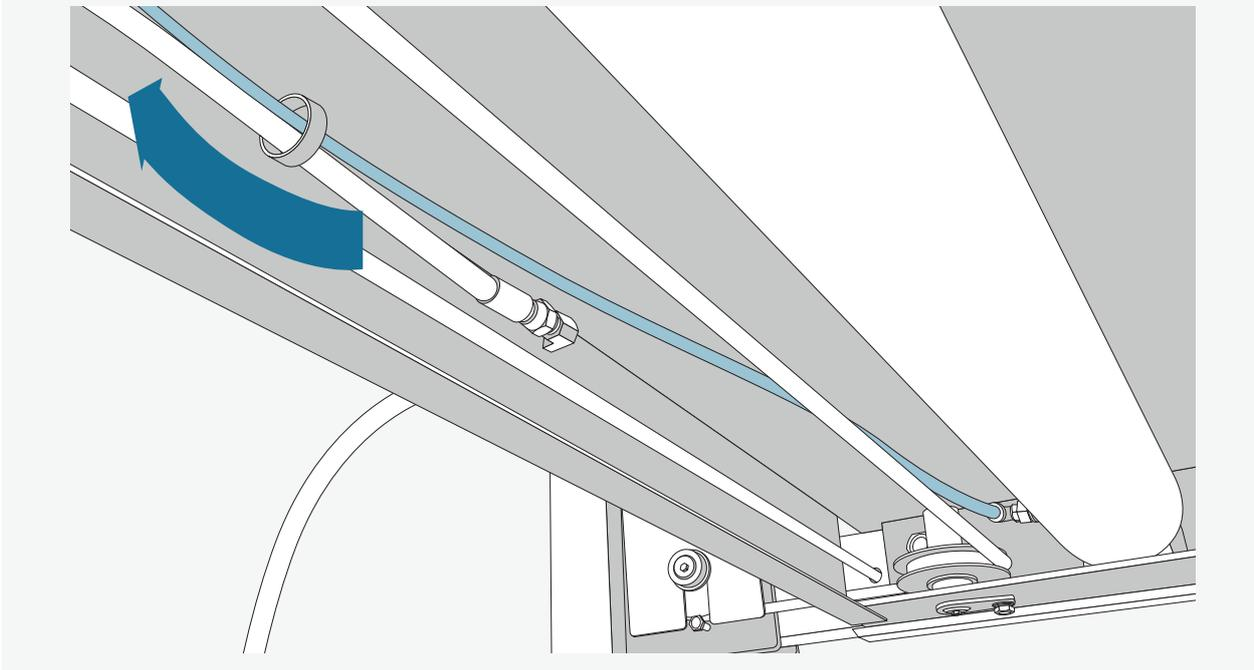
Leiten Sie den Druckluftschlauch durch die Halterung innerhalb der Hauptplattform. Der Druckluftschlauch behält ein offenes Ende, um den Luftausgleich des Hydraulikkreislaufs zu gewährleisten.
