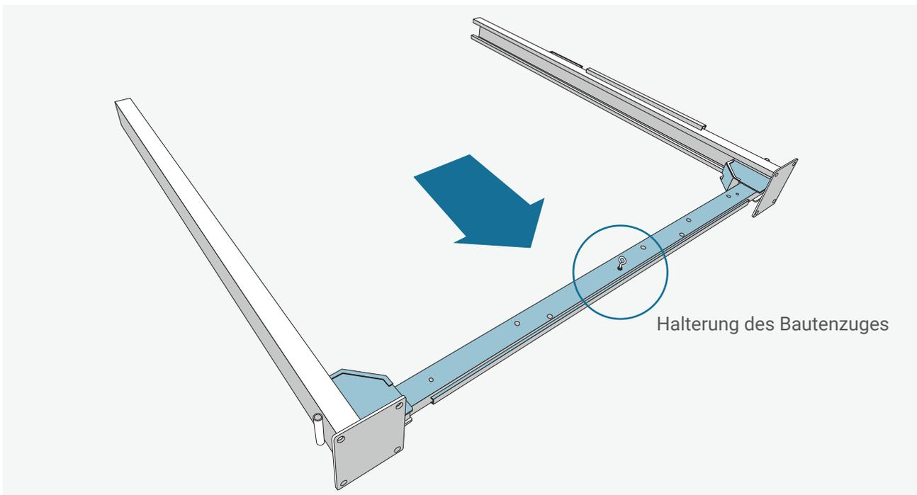
Schieben Sie die Quertraverse bis zu den Säulenfüßen durch.
