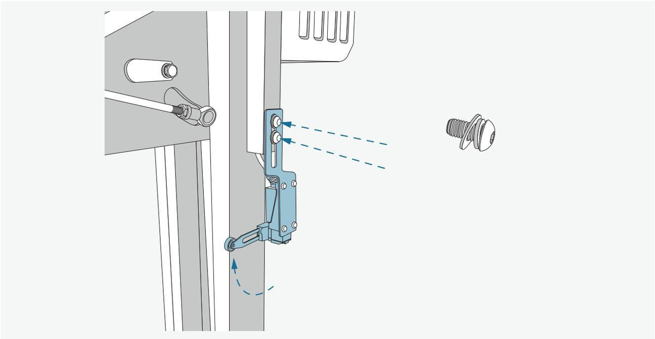
Befestigen Sie die Halterung samt Endabschalter am Kabelkanal der Säule x1 und klappen Sie den Tastarm des Endabschalters wie dargestellt nach oben.
