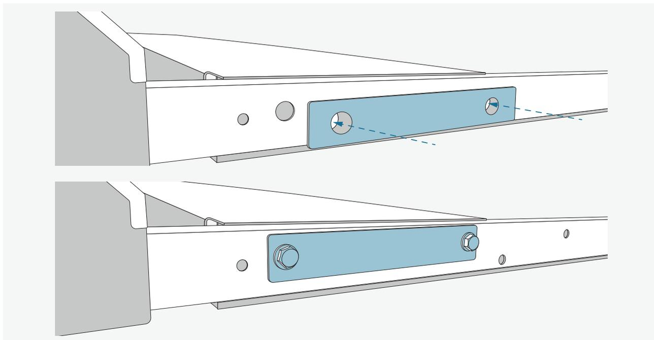
Schrauben Sie die Nebenplattform mit den Auffahrampenhalterung beider Seiten der Quertraversen fest.
