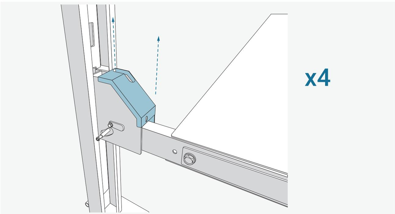
Und entfernen Sie anschließend die vier Abdeckungen.
