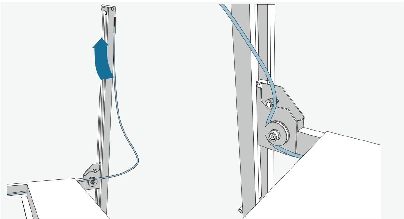
Die Gleichlaufseile müssen später in der Säulenabdeckung verschraubt werden. Geben Sie dem Gleichlaufseil genug Raum, ohne Spannung auszuüben. Achten Sie auf darauf, das Seil durch die Gleichlaufrollen zu leiten.
