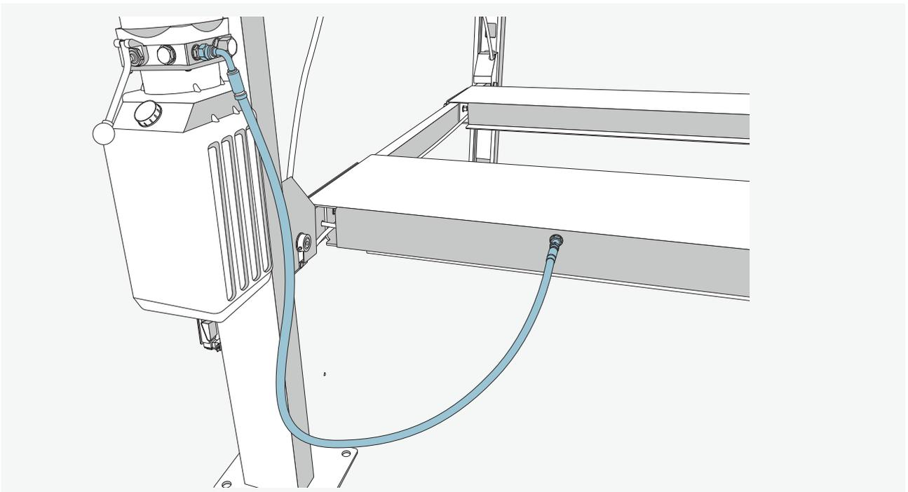
Schrauben Sie den Hydraulikschlauch an das montierte Reduzierstück (Seite 26) an.
