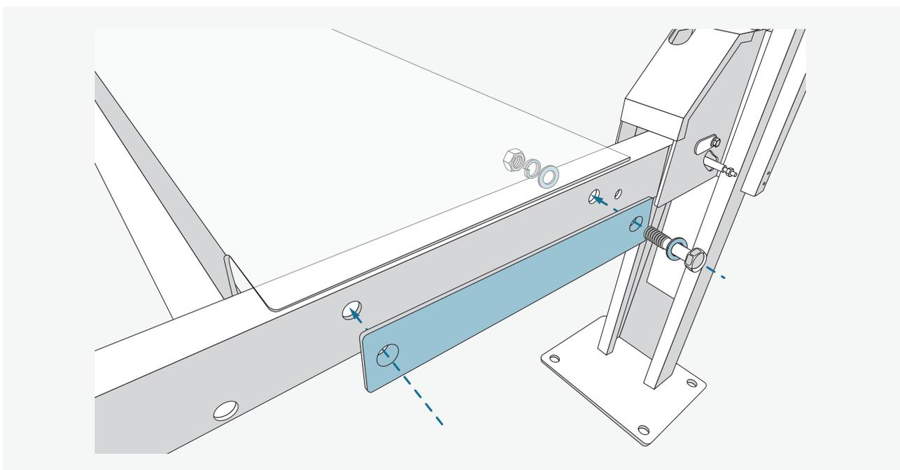
Montieren Sie die Hauptplattform genauso wie die Nebenplattform an den Quertraversen.
