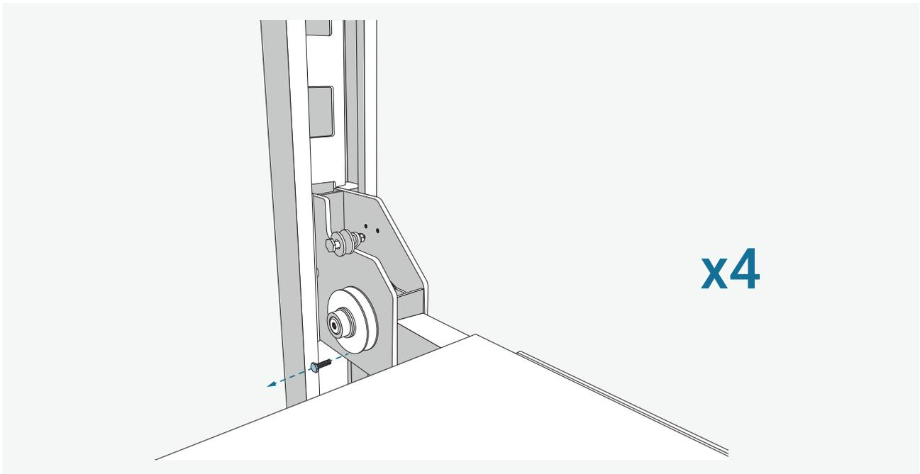
Entfernen Sie anschließend die Schraube der Gleichlaufrolle an der Quertraverse.
