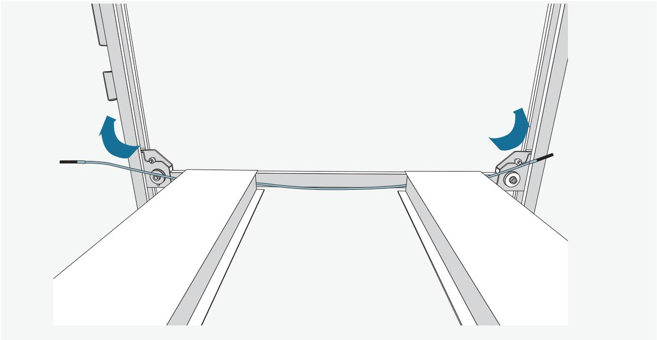
Ziehen Sie an beiden Enden des Gleichlaufseiles um genügend Freilauf zu erzeugen.
