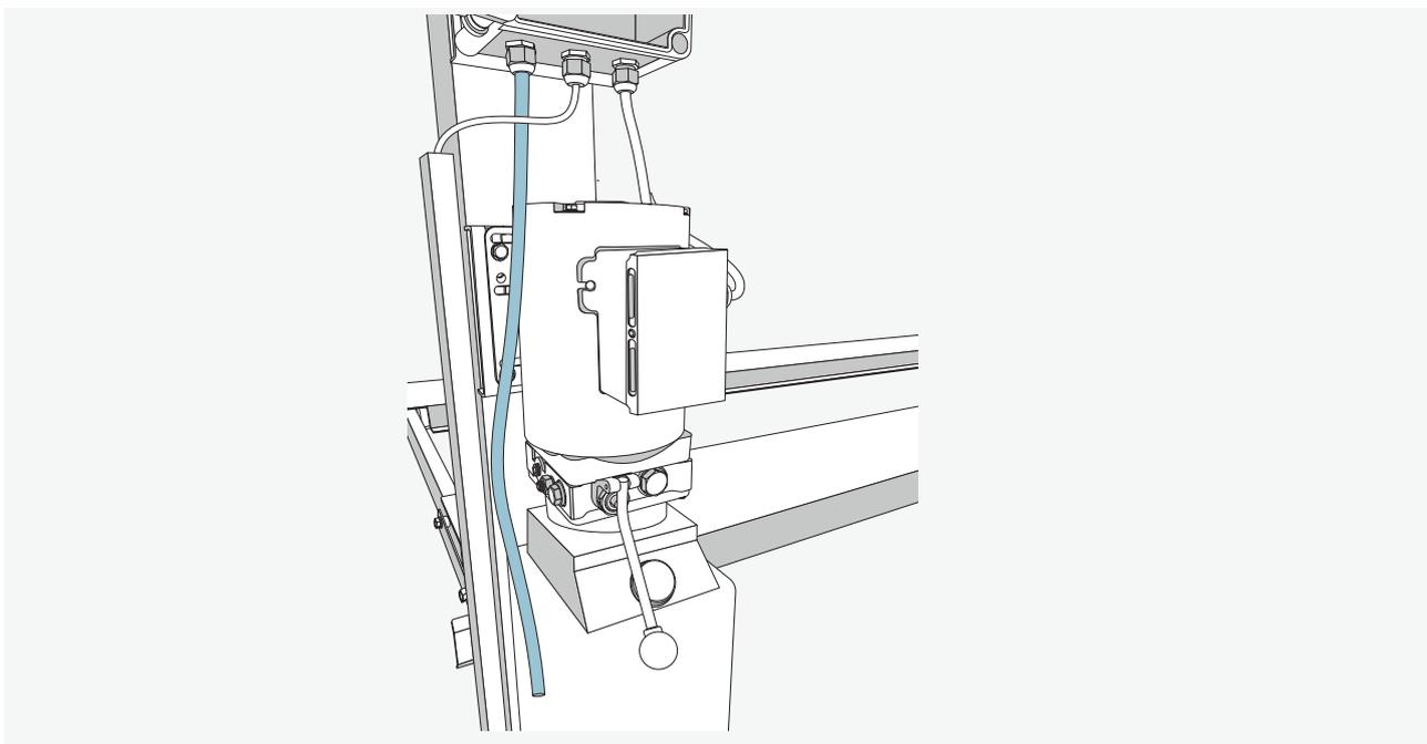
Legen Sie die Anschlüsse des Stromkabels vom Bedienpult frei.
