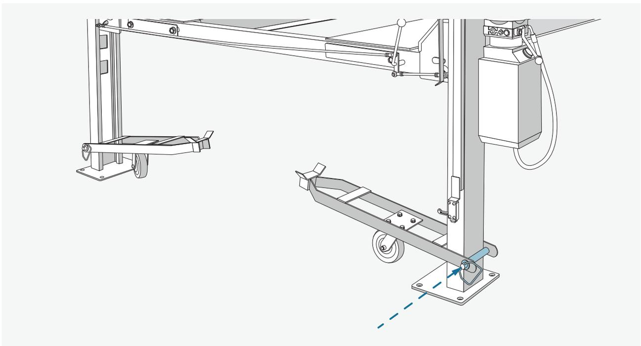
Befestigen Sie die Rollen des Mobilkits mithilfe des Stiftbolzens (x1) an der Hebebühne.
