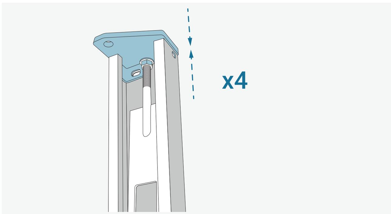
Befestigen Sie die Sicherheitsraste in der Säulenabdeckung.
