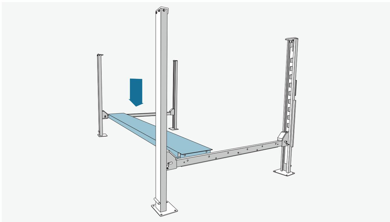
Legen Sie die Nebenplattform ( $\beta$ ) auf die beiden Quertraversen der Säulen. Die Nebenplattform erkennt man daran, dass sie keinen Hydraulikzylinder an der Unterseite hat und somit auch keine Hydraulikschläuche angeschlossen werden müssen.
