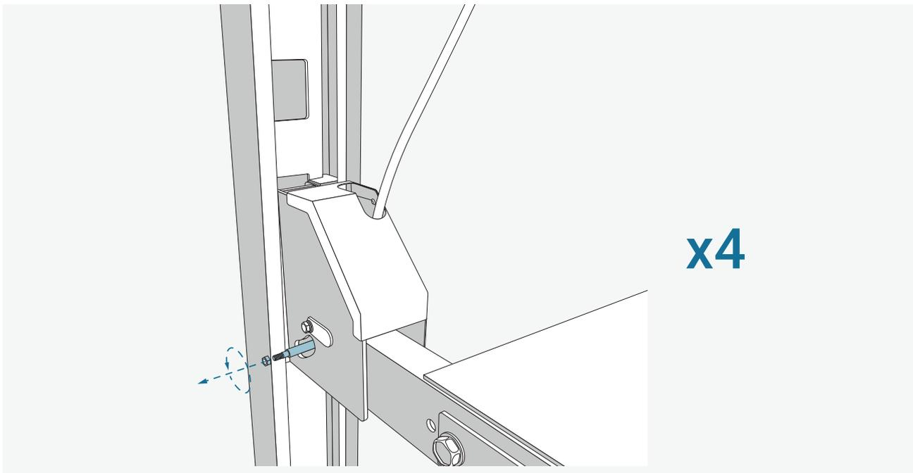
Entfernen Sie die Schraube auf den Sicherheitsrastenhebeln.
