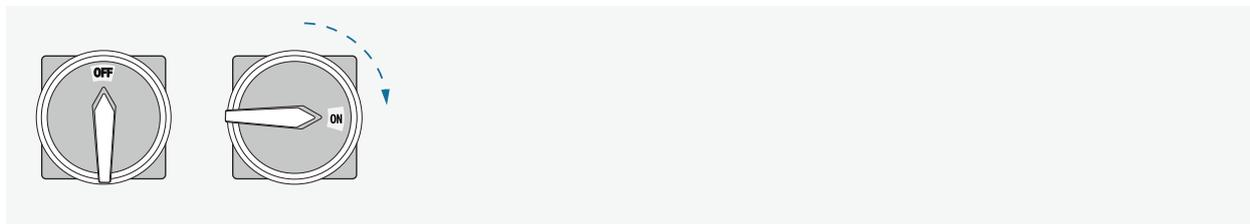
Schalter an der Seite des Bedienpults auf ON drehen.
