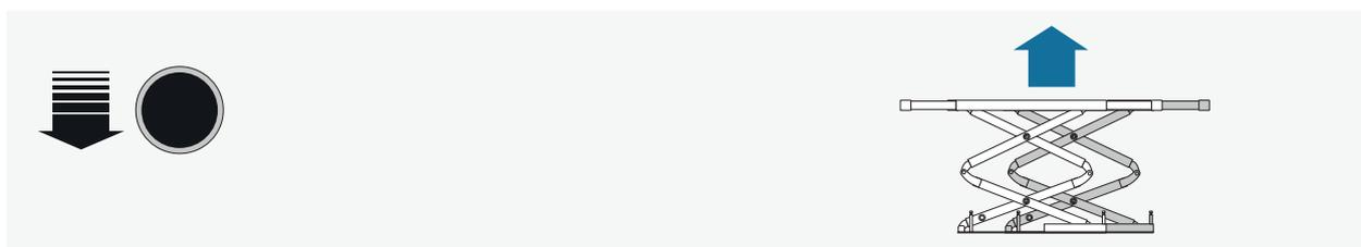
Abwärtsknopf auf der Bedienfläche gedrückt halten, die Bühne wird kurz nach oben fahren, um die Sicherheitsraste zu lösen.
