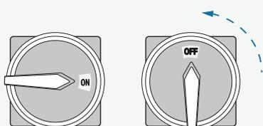
Ist die gewünschte Hubhöhe erreicht und die Plattformen verriegelt, soll das Bedienpult ausgeschaltet werden.
