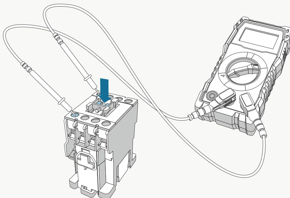
Der Motorschutz Typ B ist äußerlich etwas verschieden, funktioniert jedoch auf dieselbe Art und Weise. Stecken Sie die Dioden in die Phasenein- und ausgänge. Der Hauptschalter muss hierbei nur nach unten gedrückt werden, um den Stromdurchlauf zu testen. Wiederholen Sie den Vorgang für alle Phasen. Ähnlich auch bei Motorschutz Typ C vorgehen.
